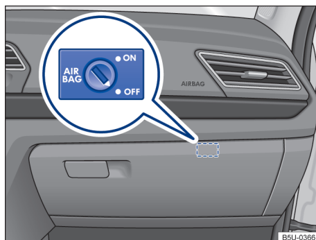
Fig. 35 En la guantera: conmutador desaccionado por la llave para apagar y encender el airbag frontal del pasajero.
