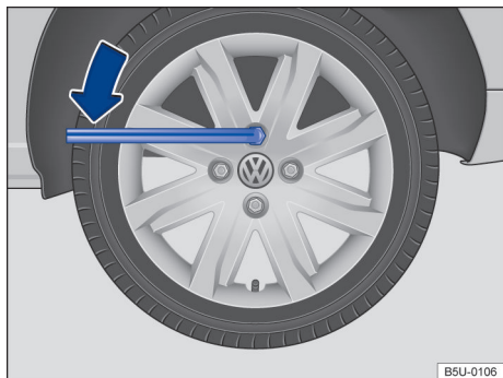
Fig. 170 Cambio de rueda: aflojar los tornillos de la rueda.
