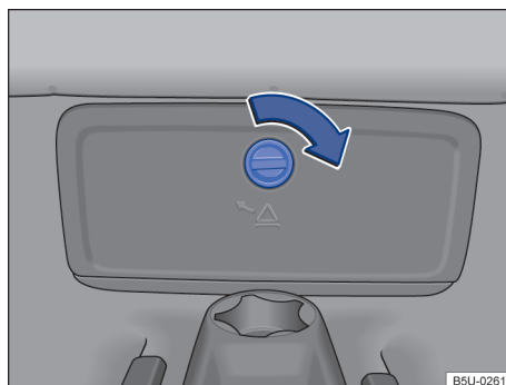
Fig. 128 En el piso del asiento trasero: acceso a la caja de fijación de las herramientas de a bordo.
