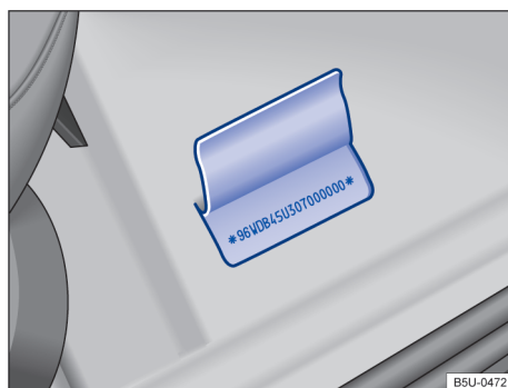
Fig. 177 Frente al asiento del pasajero: número de identificación del vehículo (número del chasis) en el piso, frente al asiento del acompañante.
