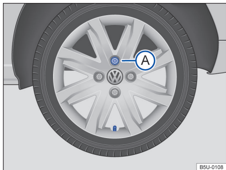
Fig. 173 Cambio de rueda: secuencia de desmontaje de los tornillos de la rueda.
