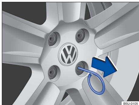
Fig. 168 Retirar las caperuzas de los tornillos de rueda.
