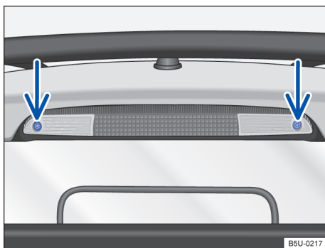
Fig. 141 En el compartimento de carga: remover la linterna de freno elevada.
