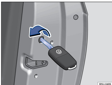
Fig. 45 Cierre de emergencia del vehículo con la llave del vehículo.
