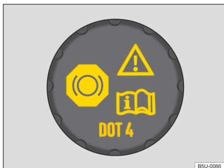
Fig. 158 En el compartimento del motor: tapón de cierre del depósito del líquido de frenos.
